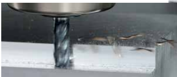
Großer Spanwinkel und einzigartiges Spannuten-Design für bessere Schärfe und exzellente Spanabfuhr.
