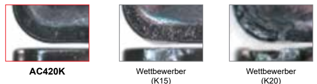
Werkstückstoff: GGG-40.3, Werkzeughalter: PCLNR2525-43, Schneidplatte: CNMG120408 Schnittbedingungen: v_c = 350\text{ m/min} , f = 0,25\text{ mm/U} , a_p = 1,5\text{ mm} , nass
