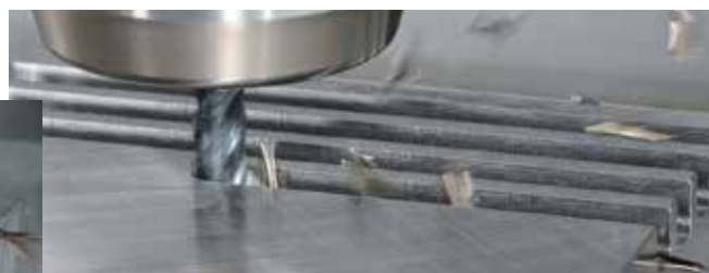
Großer Spanwinkel und einzigartiges Spannuten-Design für bessere Schärfe und exzellente Spanabfuhr.
