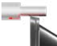
Kleiner axialer Freiwinkel -Stabile Schneide
