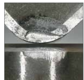
Herkömmliches Werkzeug (unbeschichtet) (nach 0,5 km)
