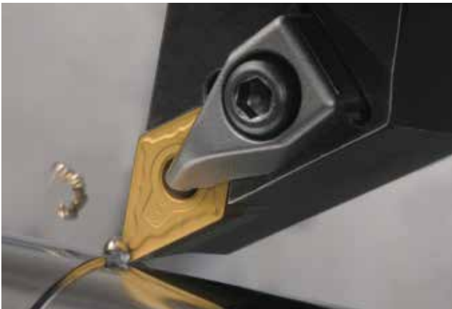
AC805P – Hochgeschwindigkeitsdrehen >300m/min
