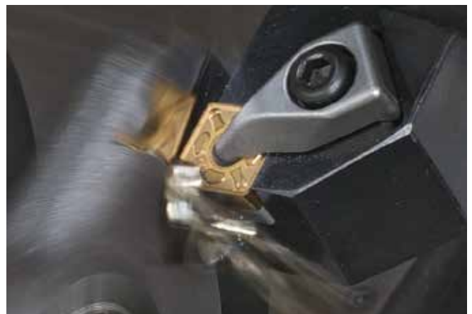
AC830P – Drehen im unterbrochenen Schnitt
