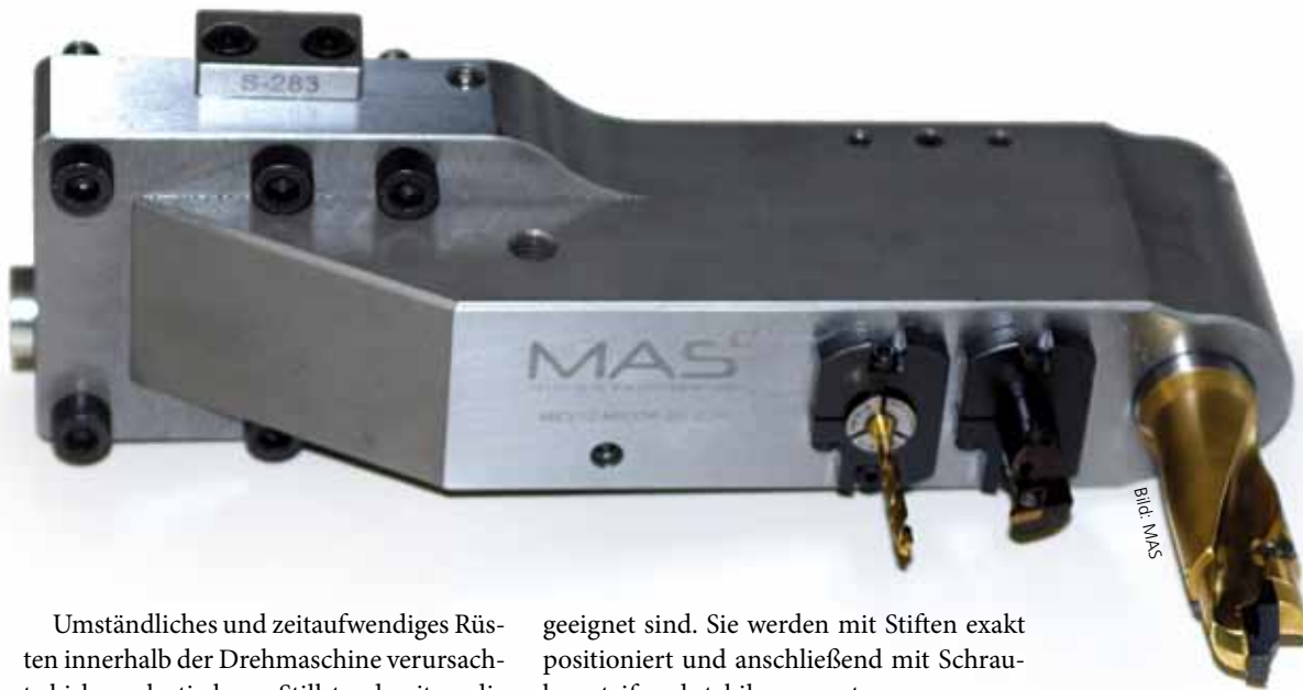
Bild 4: Der MEX-Spannblock mit drei Werkzeugplätzen sorgt bei der Komplettbearbeitung über Mehrspindel-Drehautomaten für mehr Anwendungsvielfalt.
