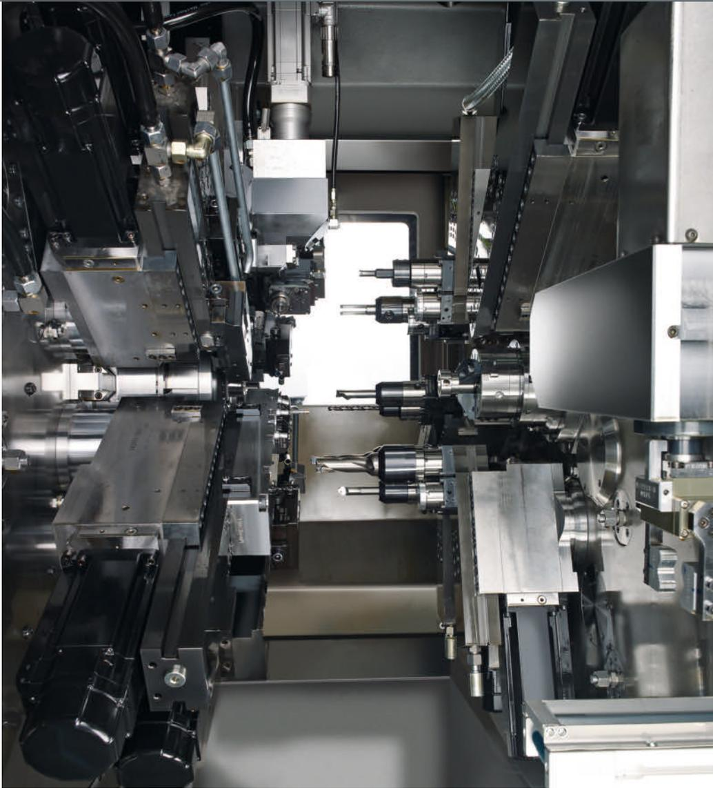
Mehr Flexibilität und kürzere Rüstzeiten für Mehrspindeldrehautomaten schafft das innovative Werkzeugspannsystem MEX
