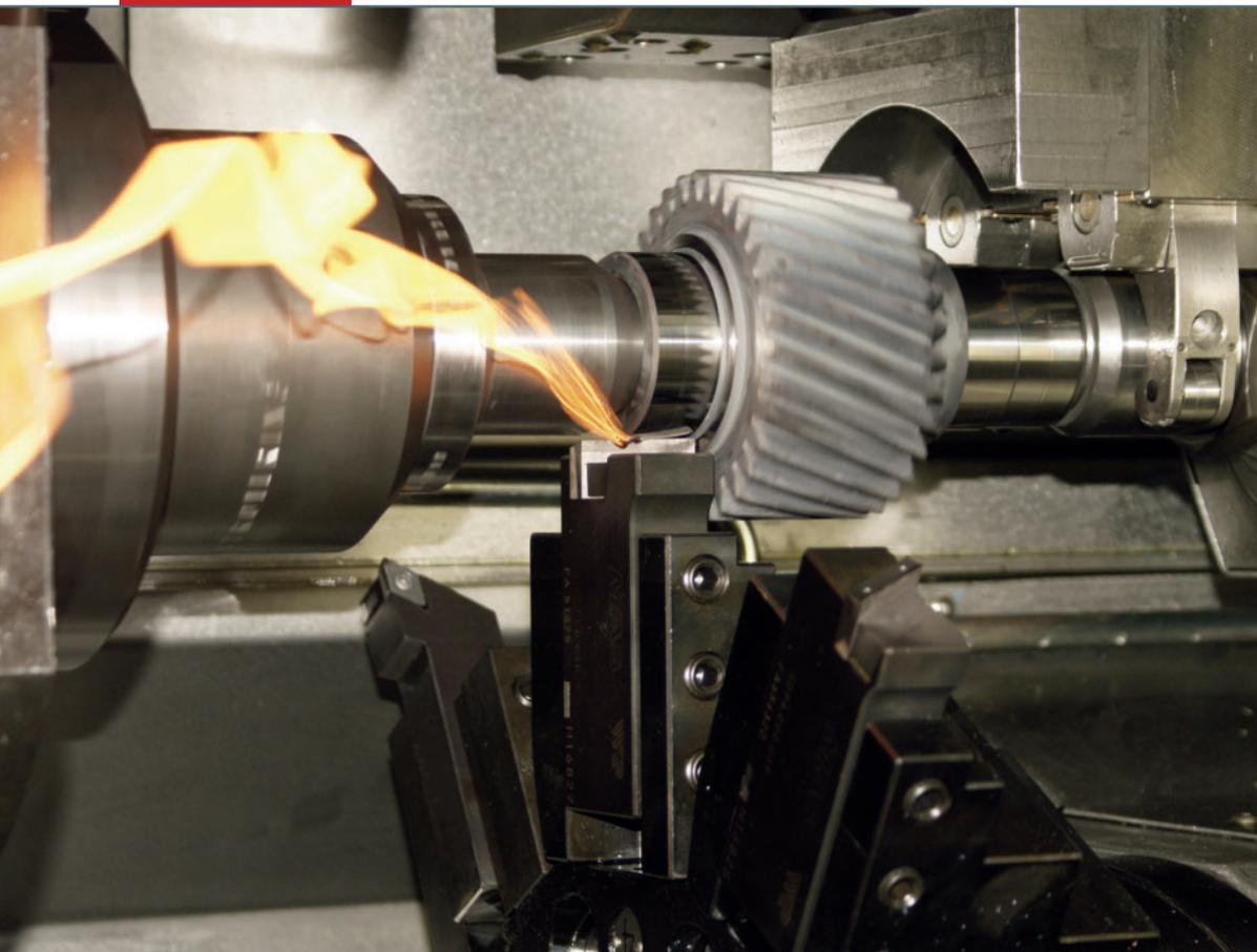
Spektakulär: Wesentlich produktiver und vor allem drallfrei bearbeitet das Rotationsdrehen gehärtete Lager- und Dichtungssitze an Wellen
