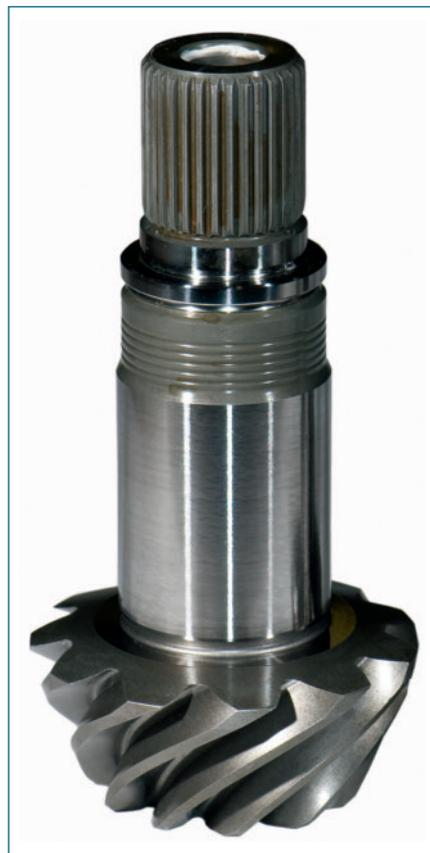
**1** Drallfrei: Rotationsdrehen kürzt umfassend die Durchlaufzeiten beim Bearbeiten typischer Getriebewellen
